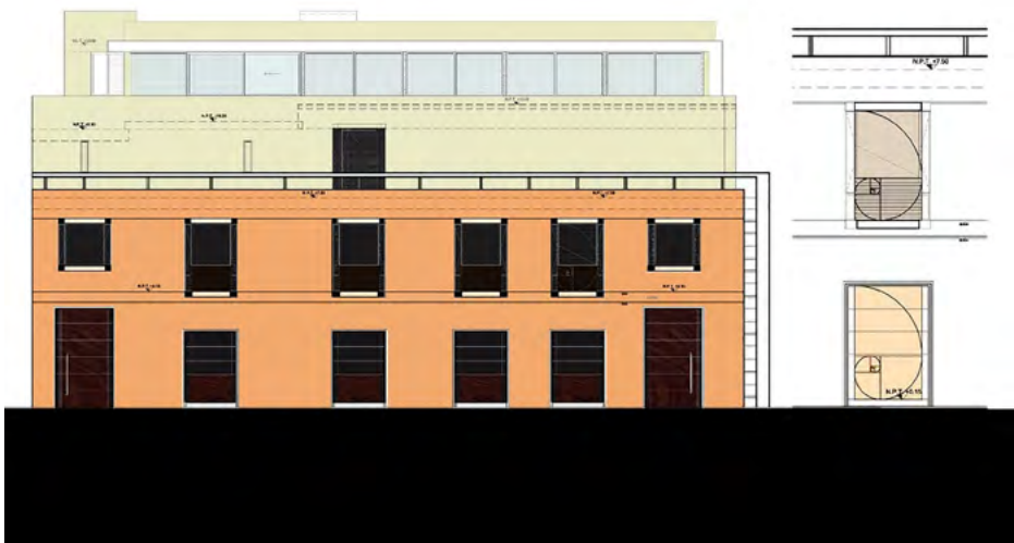
Figura 135. Proporción aurea en elementos de diseño de fachada principal (2018).
