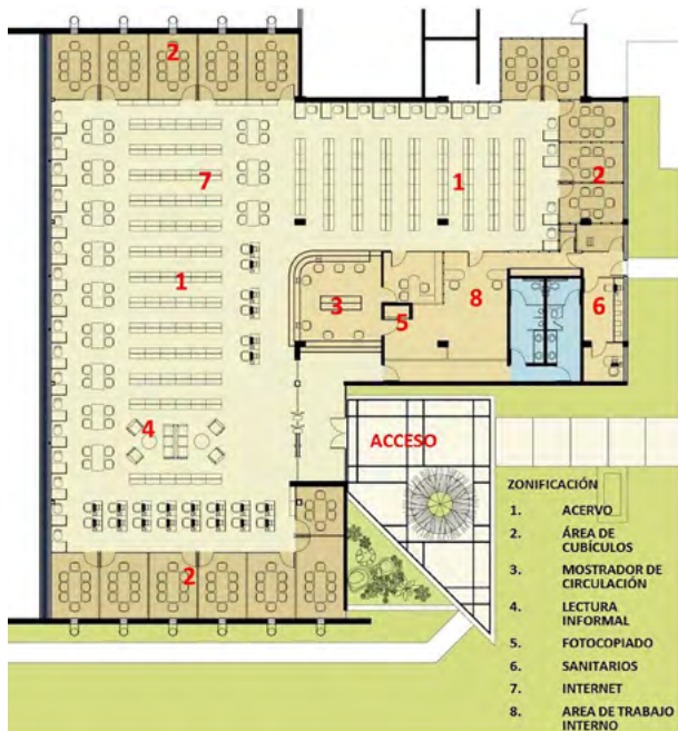
Figura 77. Planta arquitectónica del proyecto de ampliación de Biblioteca del CCBA, 2005.
